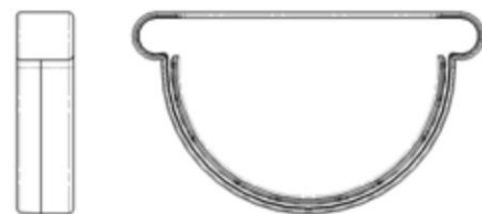
Figure 8 - Fond de gouttière
